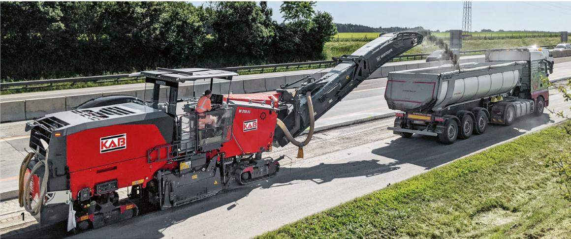
1 Großfräse / Rückseite Kleinfräse
